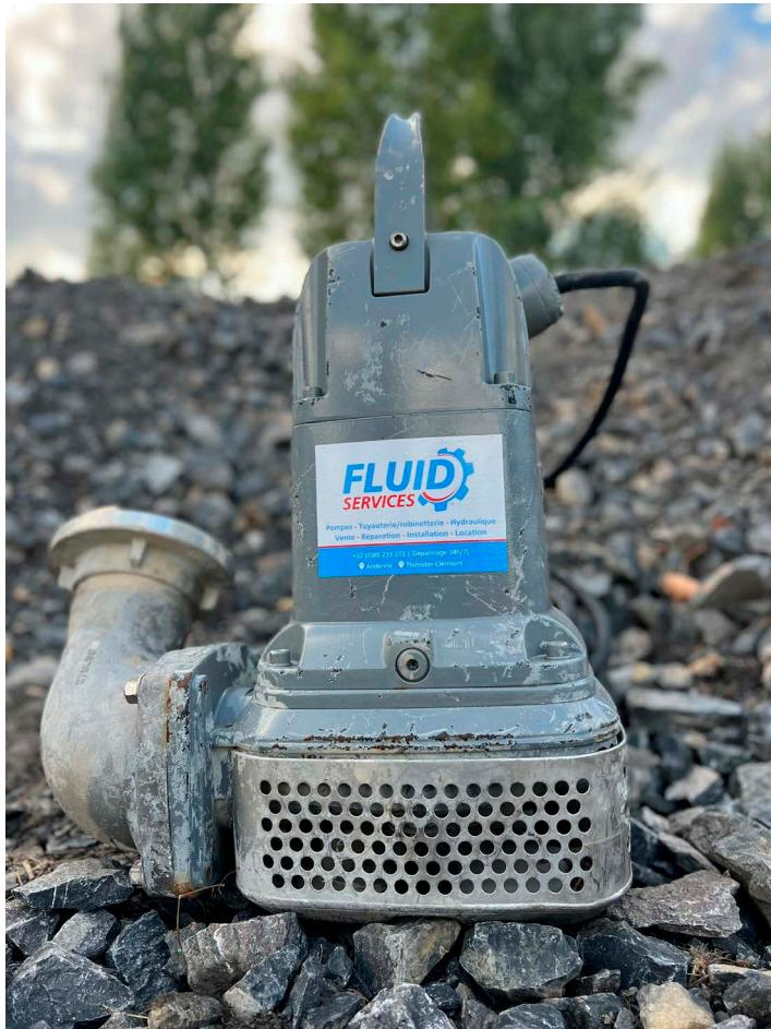
Diamètre de refoulement : 100 mm
