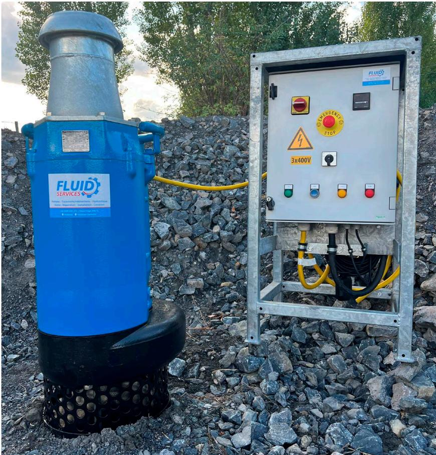
Diamètre de refoulement : 100 mm
