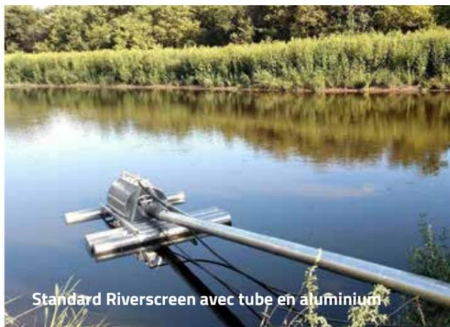
Standard Riverscreen avec tube en aluminium
